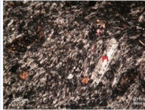
(A) Mẫu QT11/1. Trachyandesit, kiến trúc porphyr: ban tinh plagioclas (Pl) lẳng trụ dài phân bố định hướng theo phương với các vi tinh plagioclas của nền, cấu tạo dòng chảy. Những vi tinh plagioclas của nền sắp xếp song song nhau (kiến trúc trachyt).
