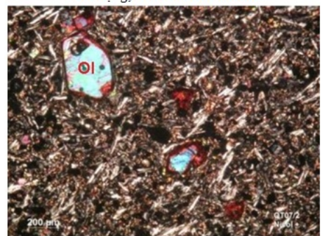
(D) Mẫu QT07/2. Trachybasalt kiến trúc porphyr với ban tinh olivin (Ol), nền kiến trúc gian phiến
